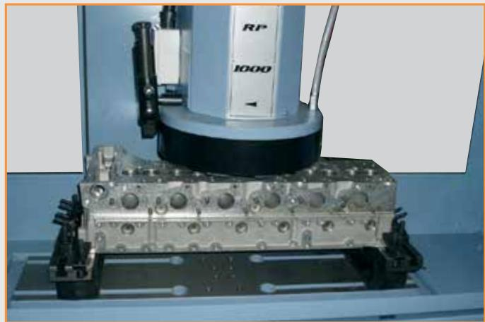
La RP1000 è una spianatrice destinata al ricondizionamento di testate e blocchi motore di vetture e veicoli industriali nonché di tutte le superfici piane che necessitano di una precisione perfetta delle superfici di contatto. Gli elementi componenti la macchina quali basamento, tavola, colonna e testa sono realizzati in ghisa di ottima qualità e fortemente nervata per offrire elevate caratteristiche di rigidità e robustezza.
