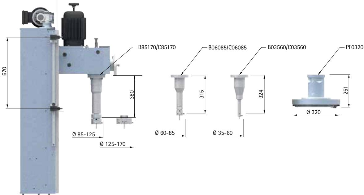
L'alesatrice cilindri AC170 è stata realizzata per rispondere all'esigenza di ricondizionamento dei blocchi motore di vetture ed autocarri con diametri compresi tra 35÷170 mm. Le ottime qualità di finitura e precisione che la contraddistinguono sono il frutto di una combinazione tra uno schema meccanico ormai collaudato e l'introduzione di soluzioni tecniche innovative che la rendono ancor più performante e versatile.
